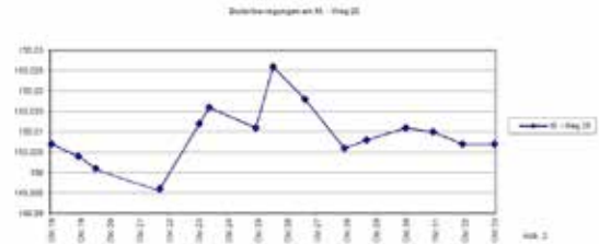
Abb. 14: Senkungs-/Hebungsverlauf in Witten über tagesnahen Bergbau.
